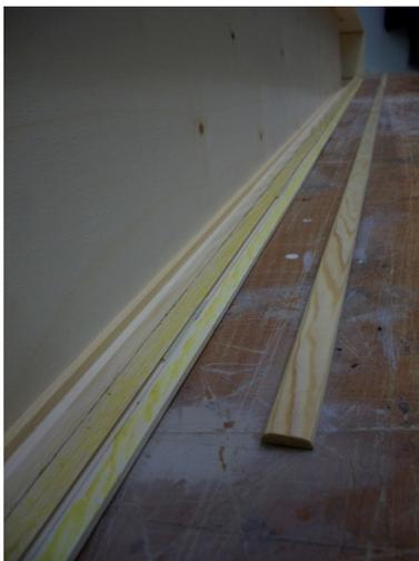
Zuerst wird die sogenannte Feder mit Kontaktkleber an den Kistendeckel geklebt. Am unteren Kistenteil wird anschliessend eine Nut installiert.
