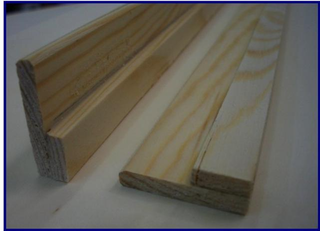
Die Feder des Deckels greift in die Nut am Kistenrand - alles passt absolut formschlüssig.
