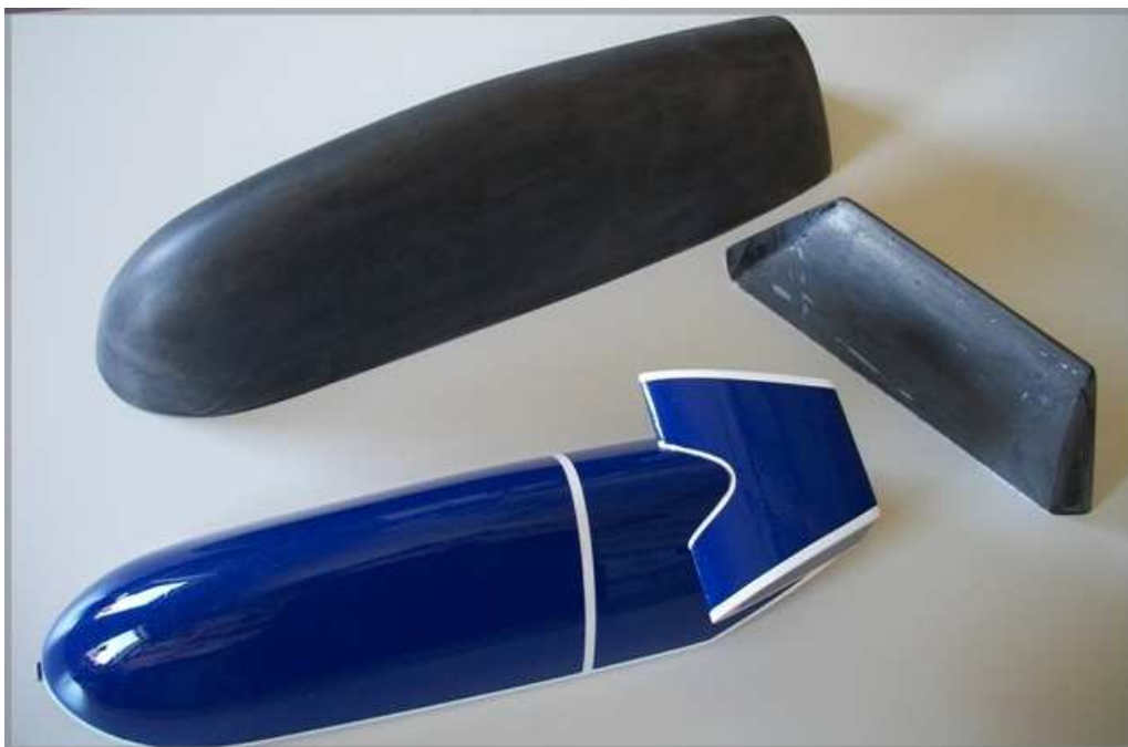
Als nächstes schicke ich die Tiefziehstempel zur Fa. Ulmer in Sonnenbühl. Dort lasse ich mir einige Hauben auf Vorrat ziehen.
